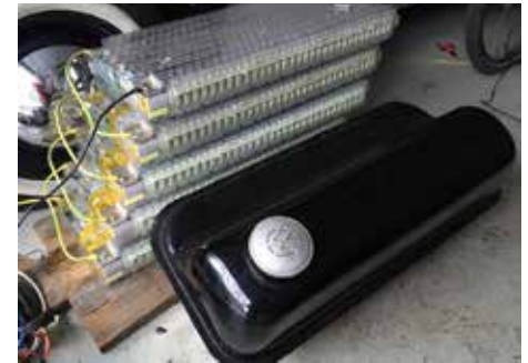
Die Akkus brauchen mehr Platz und sind auch deutlich schwerer als ein gefüllter Benzintank
